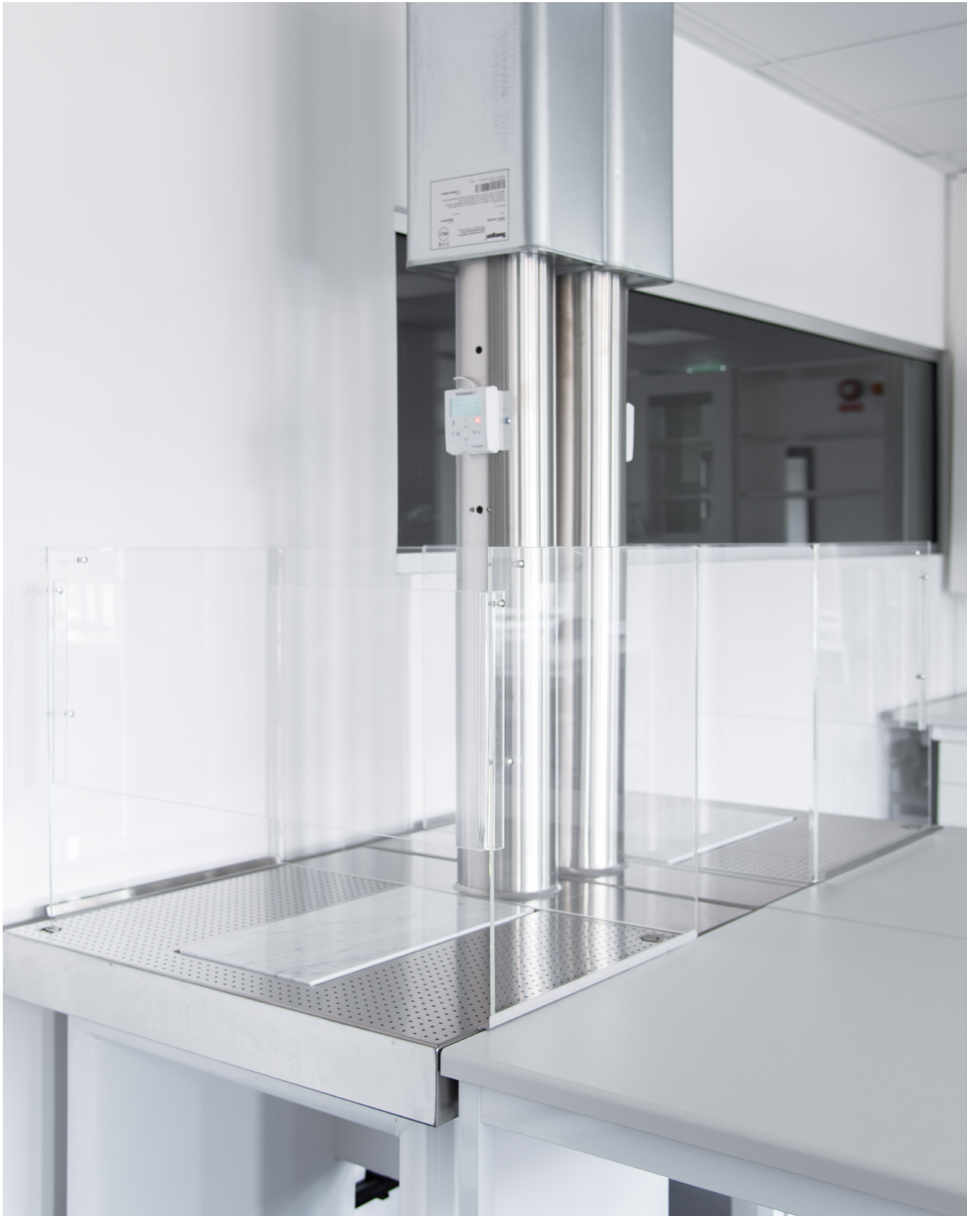
Skyddshuv placerad på ventilerad vågplats.
